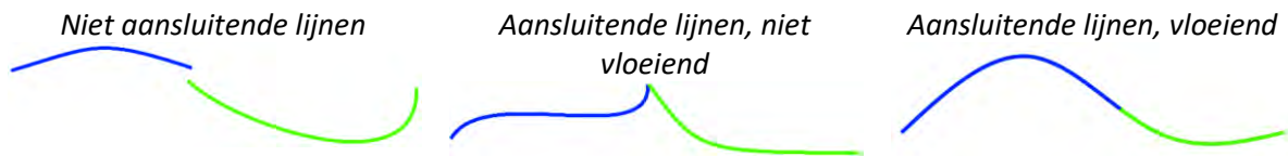
Figuur 22 Maten van vloeiendheid van de aansluiting van twee lijnen
